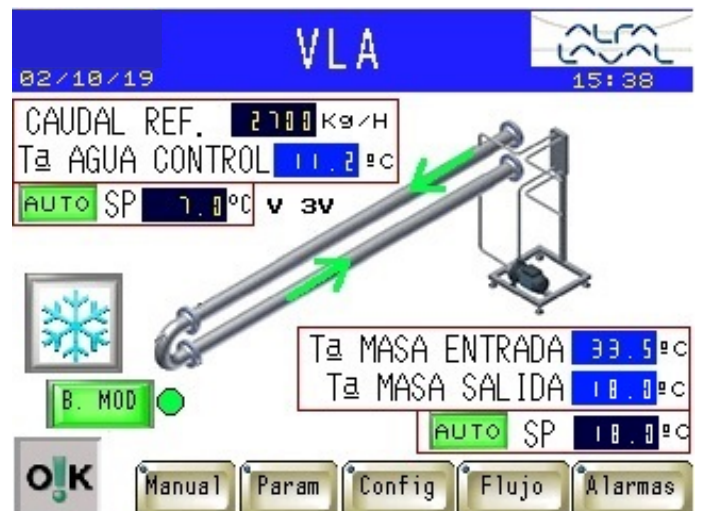
▲ Detalle display con datos de temperatura a la entrada y salida de masa en el VLA
