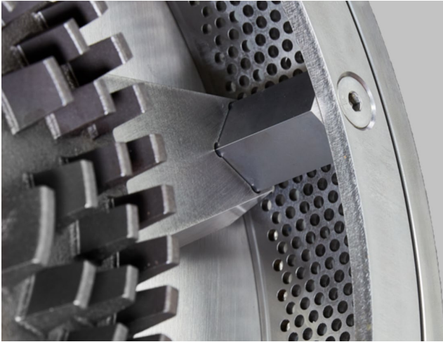
Detalle de los elementos de corte del molino de doble filo
