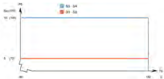
Диаграмма "давление–температура" для модели СВ16 (соответствует нормативам PED)
