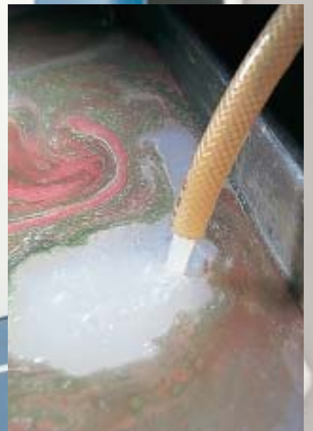
Efter rening återförs skärvätskan till tanken.
