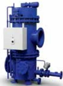
Фильтр с размером ячеек 50 мкм используется при операциях приема балластных вод, он блокирует всасывание сравнительно крупных организмов и уменьшает количество илистого осадка в балластных цистернах (во время дебалластировки прокачка воды идет в обход фильтра). Фильтр очищается путем автоматической обратной промывки. Для промывки используется лишь небольшая часть проходящей через систему воды.
