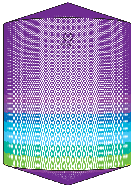
D5m H6m, Toftejorg TZ-74 versione Brew Kettle, 4 x \varnothing 6 mm, 100% Tempo = 18.2 min., consumo acqua = 3760 l
