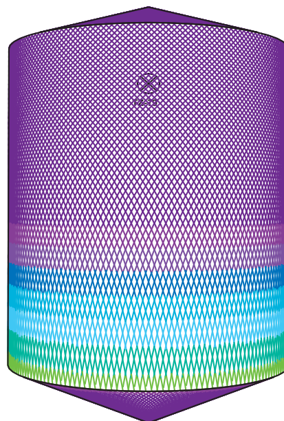
D8m H10m, Toftejorg TZ- 79, 4 x \varnothing 10 mm, 0% Время = 23.3 мин., Расход воды = 10868 l
