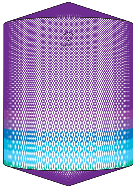
D5m H6m, Toftejorg TZ-74 itsepuhdistuva versio, 4 x \varnothing 7 mm, 0% Aika = 15.3 min, vedenkulutus = 4853 l
