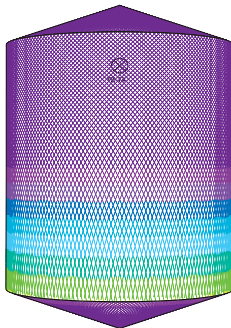
D5m H6m, Toftejorg TZ-74 Brew Kettle Version, 4 x ø6 mm, 100% Время = 18.2 мин., Расход воды = 3760 l
