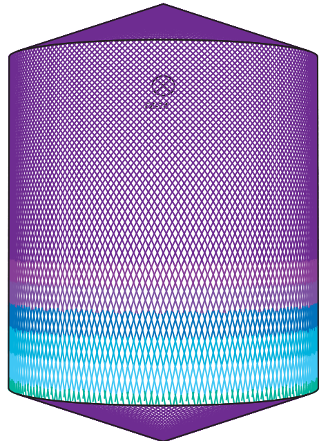
D5m H6m, Toftejorg TZ-74 в самоочищающемся варианте, 4 x \varnothing 7 mm, 0% Время = 15.3 мин., Расход воды = 4853 l
