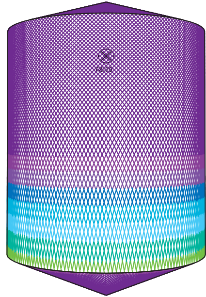
D8m H10m, Toftejorg TZ-79, 4 x □10 mm, 0 % 시간 = 23.3분, 물 소비량 = 10868 l
