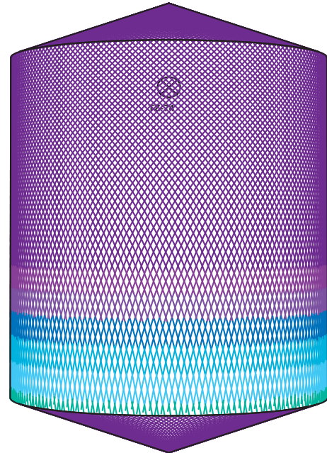
D5m H6m, Toftejorg TZ-74 itsepuhdistuva versio, 4 x \varnothing 7 mm, 0% Aika = 15.3 min., vedenkulutus = 4853 l
