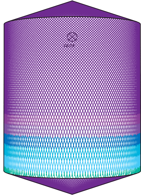
D5m H6m, Toftejorg TZ-74 자가 세정 버전, 4 x □7 mm, 0% 시간 = 15.3 분, 물 소비량 = 4853 l
