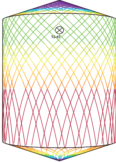
D2.5m H6m, Toftejorg TZ-67, 4 x \varnothing 6 mm Aika = 3.5 min, vedenkulutus = 727 l
