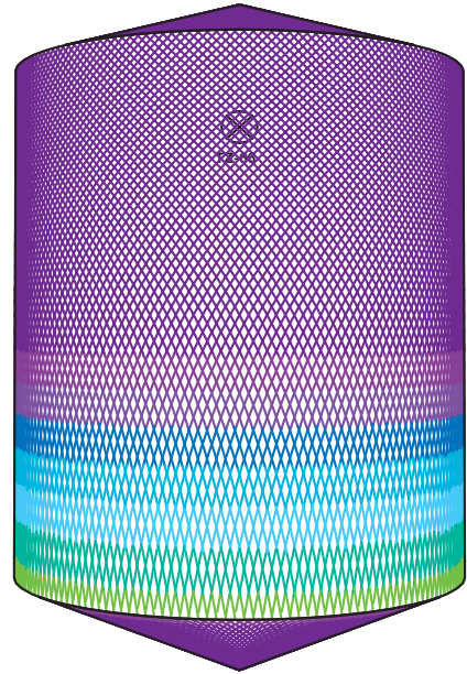
D8m H10m, Toftejorg TZ-66, 4 x □10 mm, 0% 시간 = 23.3분, 물 소비량 = 10868 l
