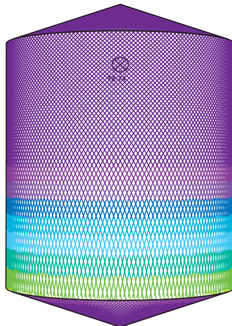
D5m V6m, Toftejorg TZ-74 ve verzi pro mladinové pánve, 4 x ø6 mm, 100 % času = 18,2 min., spotřeba vody = 3760 l
