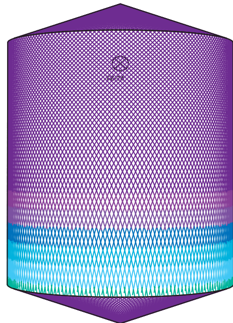
D5m H6m, Toftejorg TZ-74 w samomyjącej, 4 x ø7 mm, 0% Czas = 15.3 min., zużycie wody = 4853 l
