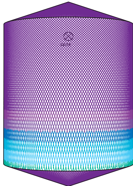
D5m H6m, Toftejorg TZ-74 wersja samomyjąca, 4 x \varnothing 7 mm, 0% Czas = 15.3 min., zużycie wody = 4853 l
