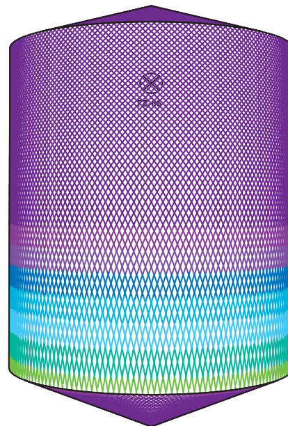
D8m H10m, Toftejorg TZ-66, 4 x \phi 10 mm, 0% Время = 23.3 мин., Расход воды = 10868 l
