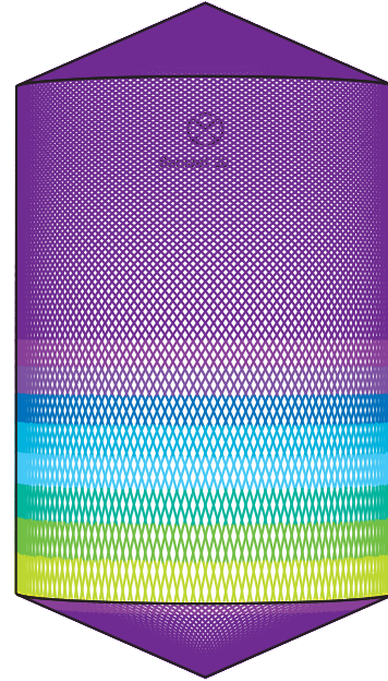
D2m H3m, Toftejorg SaniJet 20, 4 x □4.2 mm, 시간 = 7.6분, 물 소비량 = 763 l
