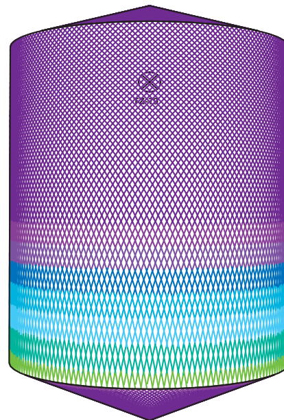
D8m H10m, Toftejorg MJ50, 4 x ø10 mm, 0 % Tempo = 23.3 min., consumo acqua = 10868 l
