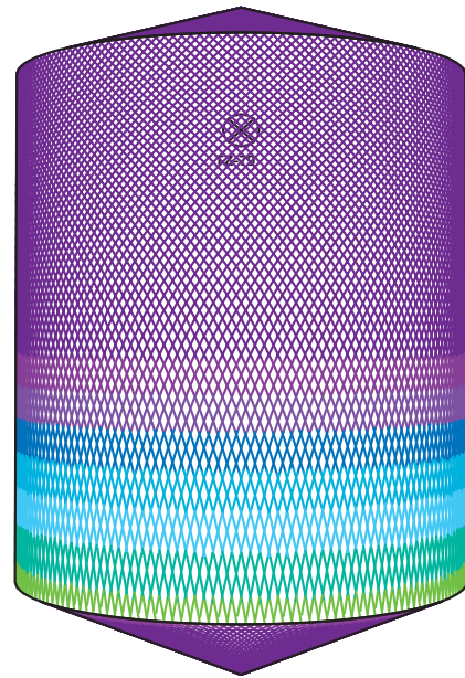
D8m H10m, Toftejorg MJ50, 4 x \varnothing 10 mm, 0 % Aika = 23.3 min, vedenkulutus = 10868 l
