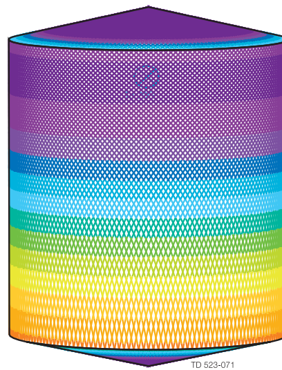
D 4,6 м Н 5,5 м, Toftejorg MultiJet 25. 4 x Ø5,5 мм, Время = 8.3 мин., Расход воды = 1612 л
