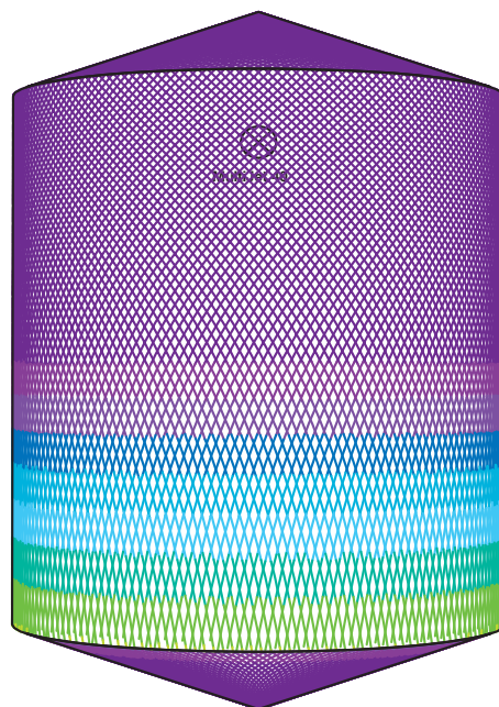
H 5 m V 6 m, Toftejorg MultiJet 40, 4 x ø6 mm, 100% Doba = 18.2 min., spotřeba vody = 3760 l
