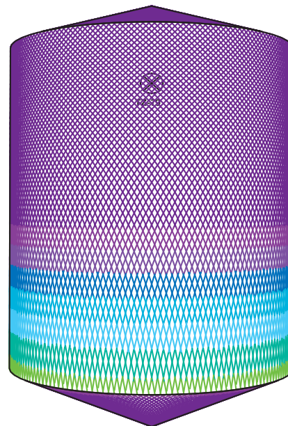
D8m H10m, Toftejorg MJ50, 4 x ø10 mm, 0 % czas = 23.3 min., zużycie wody = 10868 l
