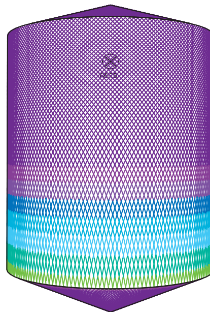
Г8м В10м, Toftejorg MJ50, 4 x ø10 мм 0 % времени = 23.3 мин., Расход воды = 10868 л
