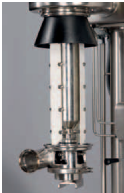
Système de relevage hydraulique et goulotte facilitant la maintenance
