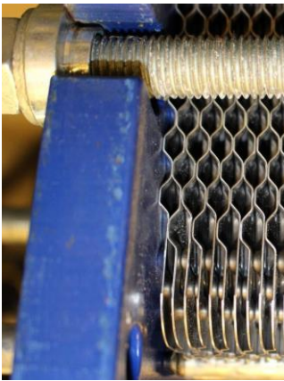
Slika 5 Jedinstveni oblik saća ploča koje proizvodi kompanija Alfa Laval ojačava ploče i omogućava smanjenje udaljenosti između otvora i ivice ploče.
