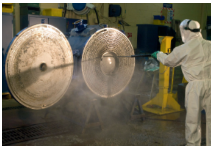
Аппарат безразборной мойки CIP используется для очищения спирального теплообменника
