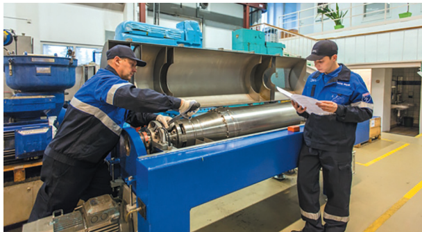
РАЗБОРКА КОМПЛЕКТНОГО ДЕКАНТЕРА
