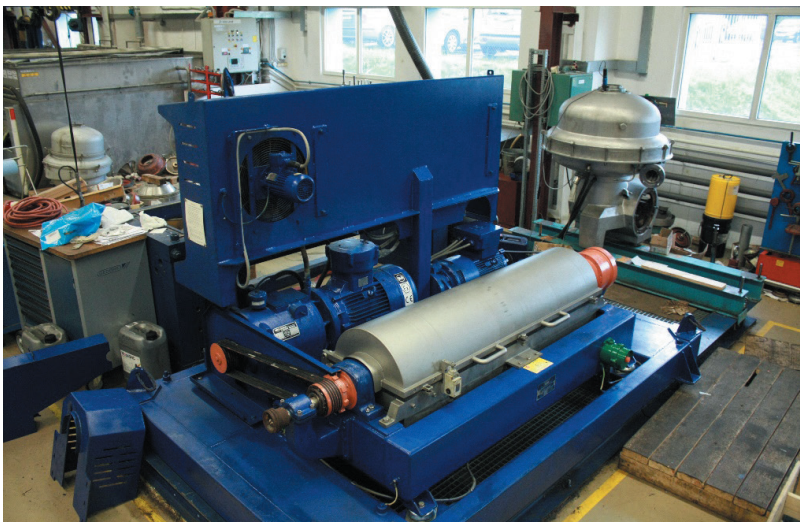
ФИНАЛЬНОЕ ТЕСТИРОВАНИЕ ОТРЕМОНТИРОВАННОГО БАРАБАНА
