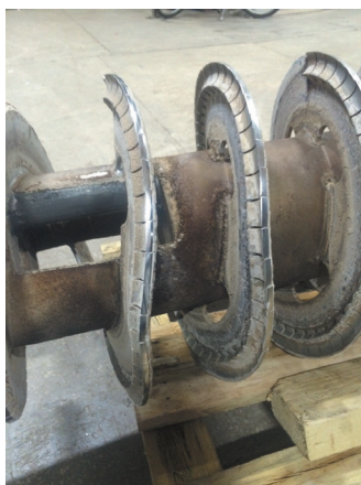
Витки шнека до и после восстановления
