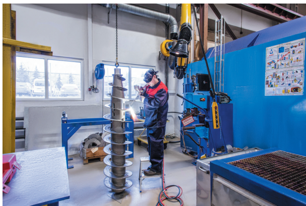
ПРОЦЕСС ПЛАЗМЕННОГО НАПЫЛЕНИЯ ТВЕРДОСПЛАВНОГО ПОКРЫТИЯ НА КРОМКУ ЛОПАСТИ ШНЕКА
