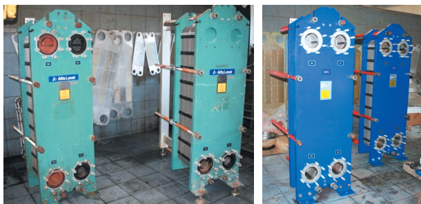
Пласти́нчатый теплообменник: до и после восстановления в Сервисном центре Альфа Лаваль
