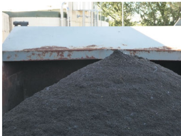
Рис. 21. Избыточный активный ил, обезвоженный на центробежном декантере Альфа Лаваль на ОС «Марчиано»
