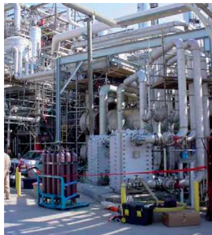
Два Comrabloc, используемые для предварительного подогрева сырой нефти (2004 год).
