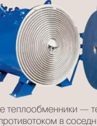
Спиральные теплообменники — теплообменники с противотоком в соседних каналах. Предназначены для работы с грубыми суспензиями (повышенная склонность к засорению) в условиях высоких температур и/или давлений.
