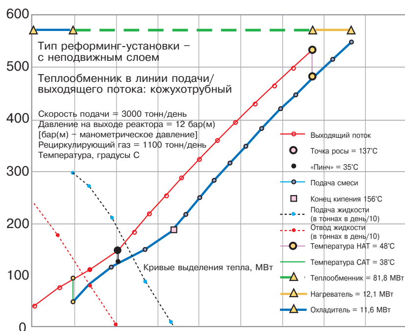
Рис. 1. Установка для каталитического реформинга с использованием кожухотрубного оборудования
