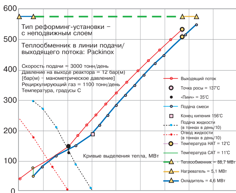
Рис. 2. Установка для каталитического реформинга с использованием теплообменника Packinox
