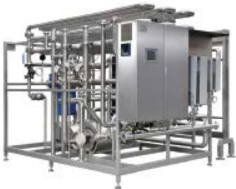
Смонтированный на раме компактный модуль Flexitherm Core с секцией выдерживания (вверху) и малой площадью основания.
