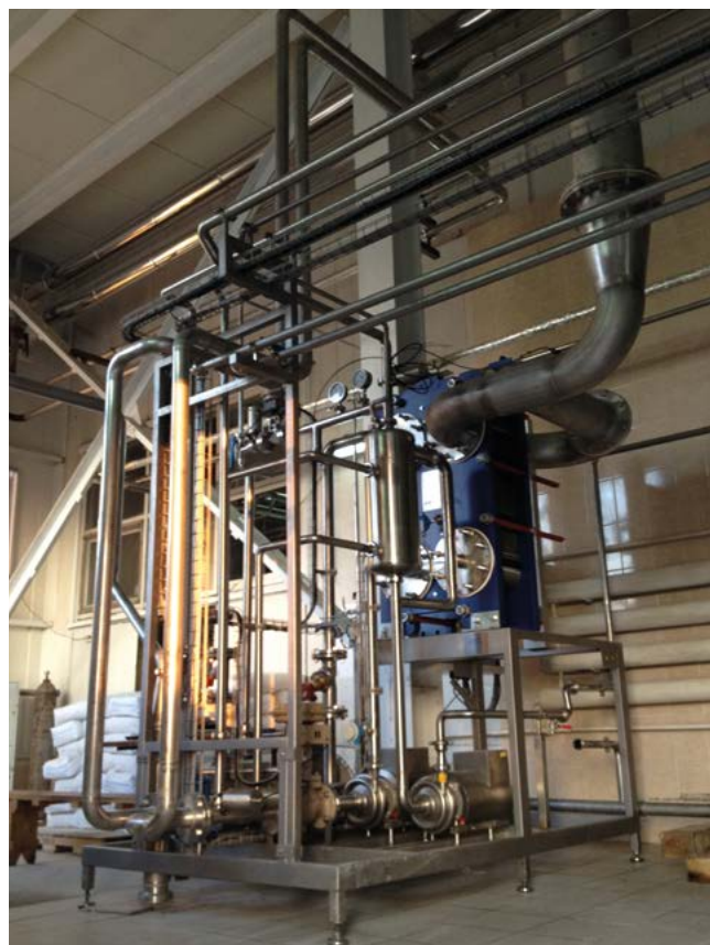
Отделение охлаждения конденсата модуля деалкоголизации
