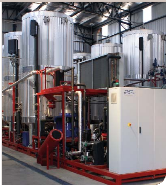
Система из двух установок производительностью 24 000 литров в сутки каждая.
