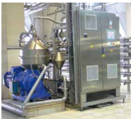
Процесс регенерации пива с использованием модуля BRUX 510
