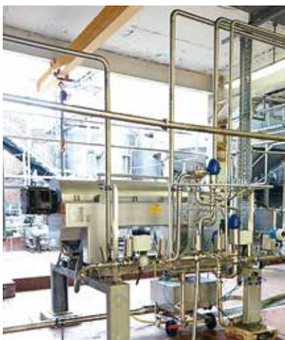
Регенерация сусла с использованием декантерной центрифуги Foodec
