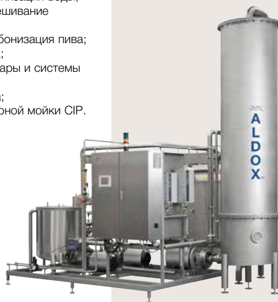
Система деаэрации воды ALDOX™
