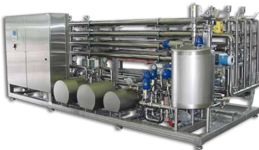
Система деалкоголизации пива с использованием мембранной фильтрации
