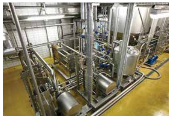
Установка для очистки пива с помощью мембранной фльтрации
