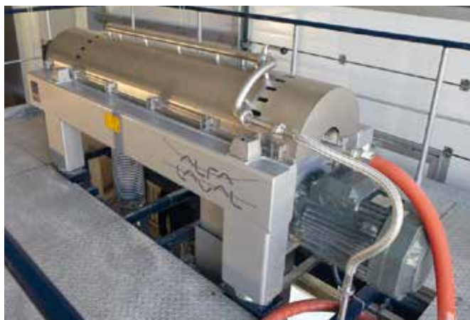
Осушение диатомита с использованием декантерной центрифуги Foodес
