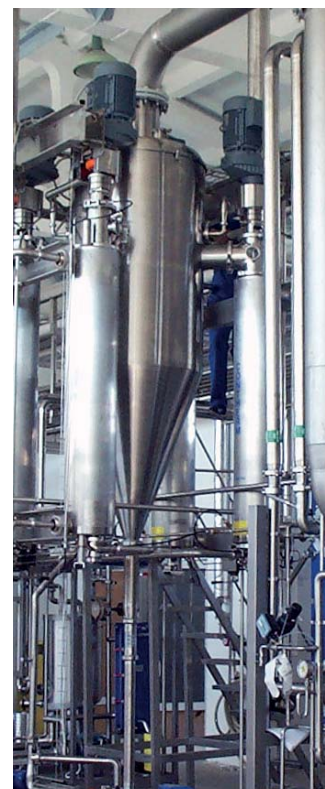
Скреповый испаритель для вязких продуктов, США
