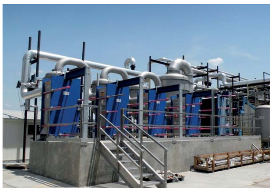
Многоцелевая система AlfaVar для выпаривания виноградного сусла, США
