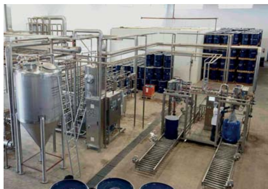
Стерилизатор и система фасовки в металлическую бочку с вкладышем в форме мешка на заводе по переработке манго, Индия
