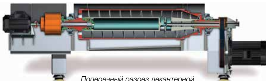
Поперечный разрез декантерной центрифуги Foodec
