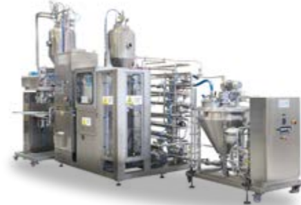
SteriTherm Ohmic – аппарат нагрева электрическим током для вязких продуктов, чувствительных к нагреву или имеющих крупные кусочки.
