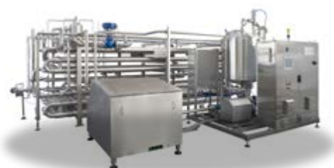
Кожухотрубный теплообменник SteriTherm для вязких и очень вязких продуктов.
