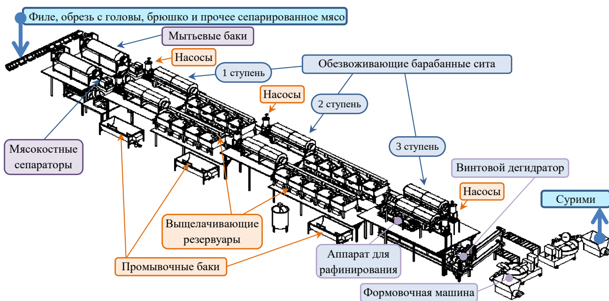
Рис. 2. Схема расположения оборудования по производству сурими по традиционной технологии 3
