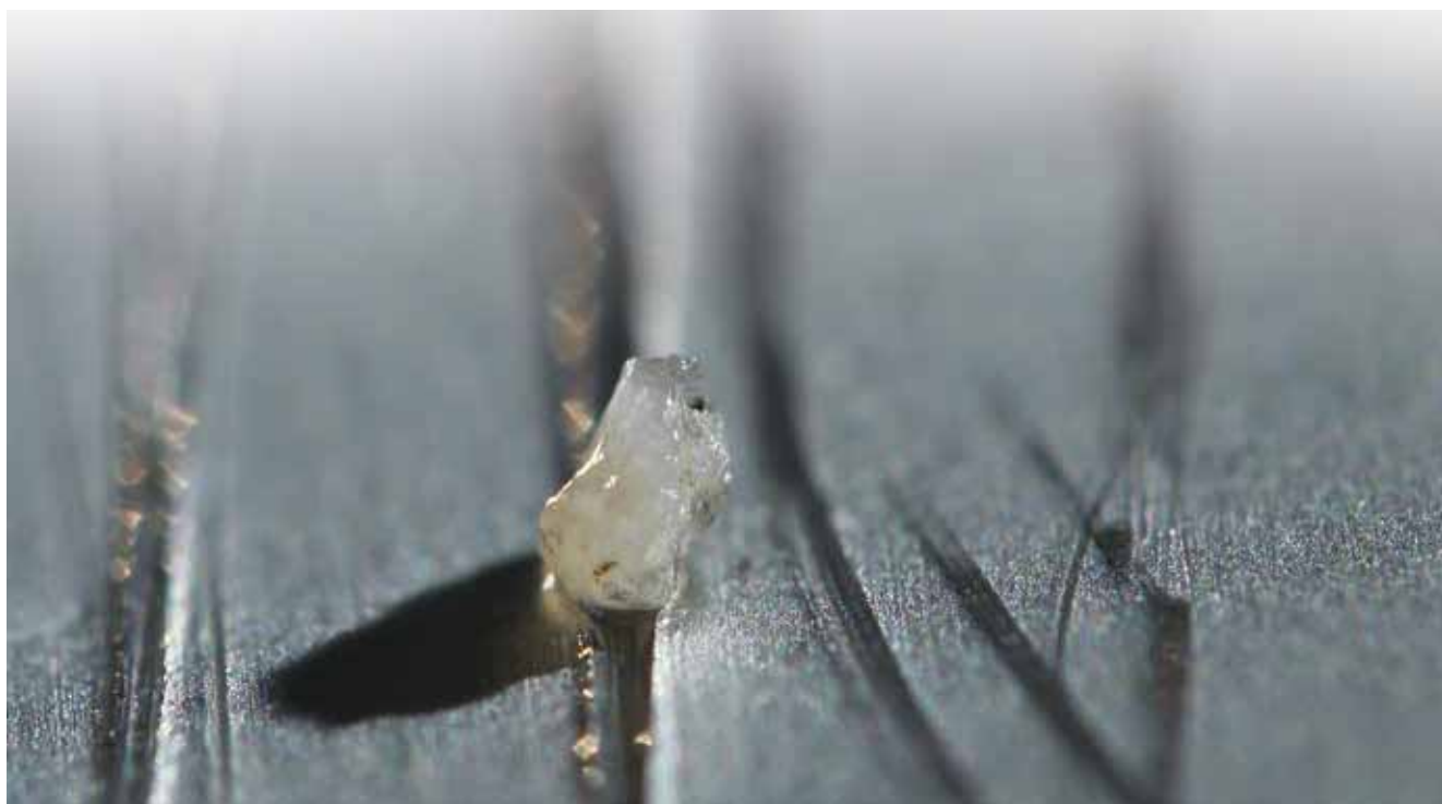
Рисунок 10. Увеличенное изображение повреждения, вызванного каталитическими частицами.
