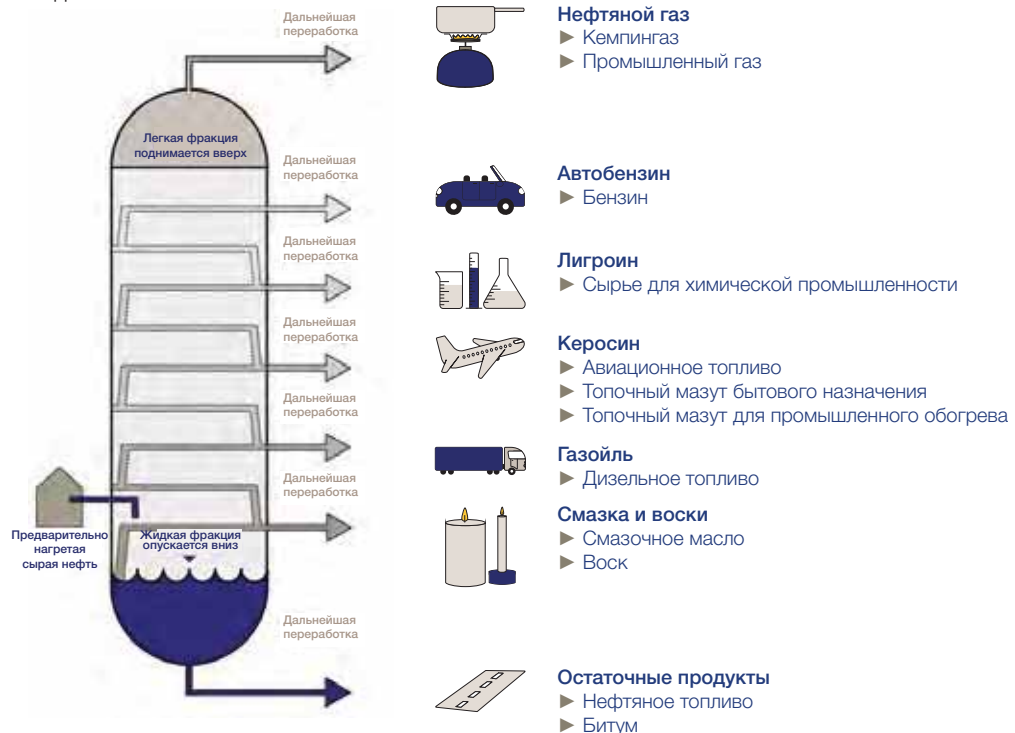
Рисунок 3. Перегонка сырой нефти с разделением на фракции. Перегонка проводится как непрерывный процесс в ректификационной колонне.
