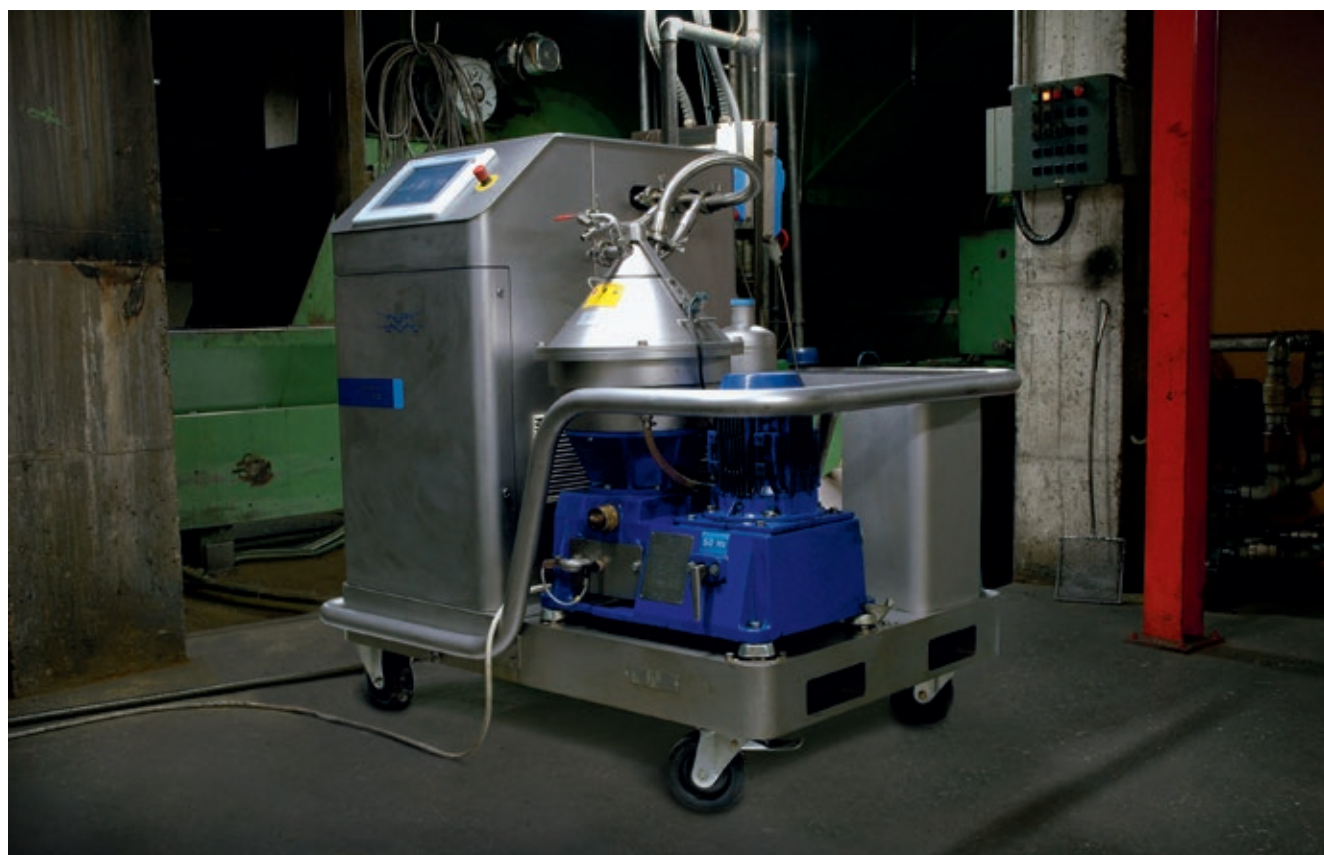
Выполненная на базе центробежного сепаратора и подключенная к резервуару с СОЖ модульная сепарационная система AlfaPure ведет непрерывную очистку СОЖ, удаляя масляный трамп и механические примеси диаметром всего в несколько микрон.
