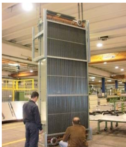
Последний этап технологического процесса изготовления охладителя трансформаторного масла AlfaBlue на заводе воздушных теплообменников Альфа Лаваль в Италии.
