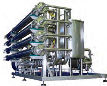
Układ filtracji na membranach spiralnych dla aplikacji drożdżowych.
