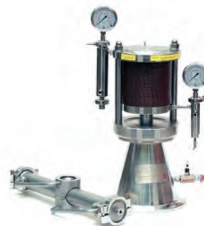
LabStak M20, idealny układ dla prac badawczo-rozwojowych, testów jakości, jak również optymalizacji i zwiększania skali procesów prowadzonych w instalacjach pilotażowych.
