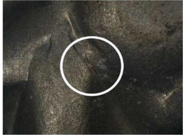
권장 사양보다 12% 더 두꺼운 가스켓을 사용하여 발생한 균열의 확대 이미지 (첫 번째와 마지막 플레이트 사이의 거리가 너무 멀어 균열 발생)
