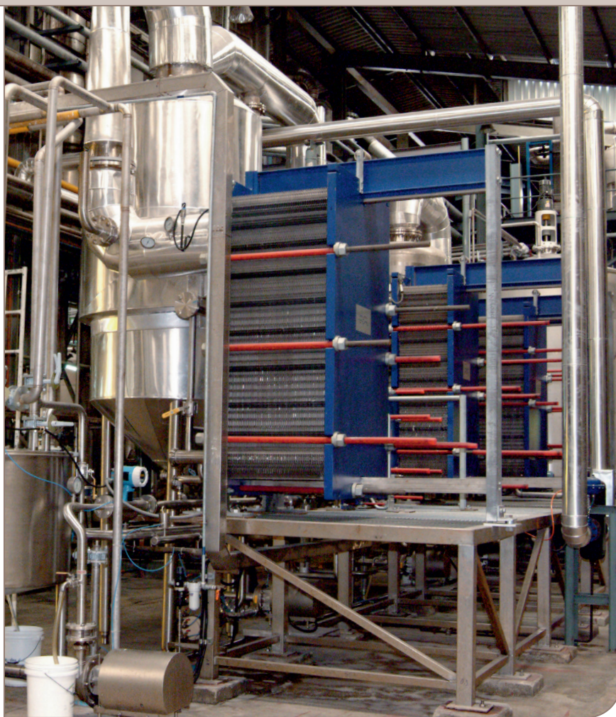
タイ・グルコース社（バンコク）に設置したフルクトース用3重効用プレート式蒸発濃縮装置 AlfaVap システム
