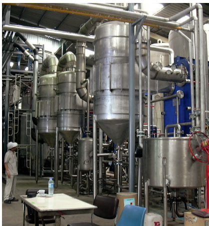
デキストロースおよびマルトース用 2 重効用プレート式蒸発濃縮装置 AlfaVap システム
