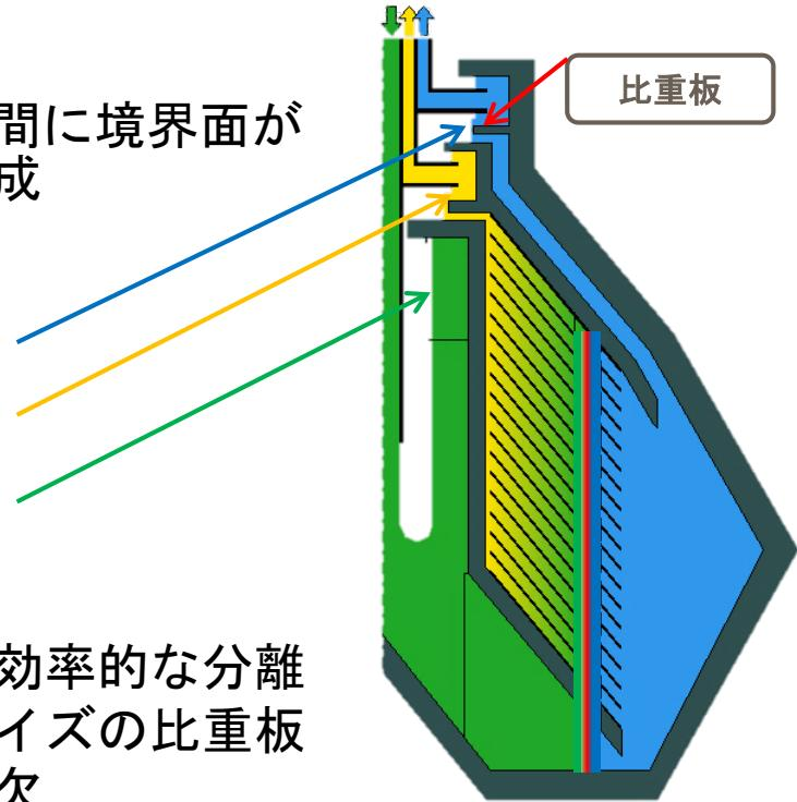
従来型の分離機では、効率的な分離を行うために正しいサイズの比重板を使用することが不可欠
