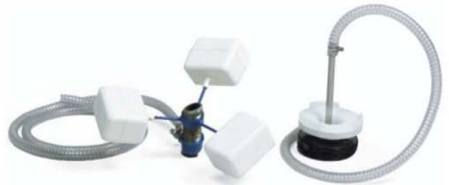
标准配件中包含一套浮子式吸入装置（左）。 选配件波纹管式吸入装置（右）适用于窄小空间和较浅的罐体（不超过100毫米）。
